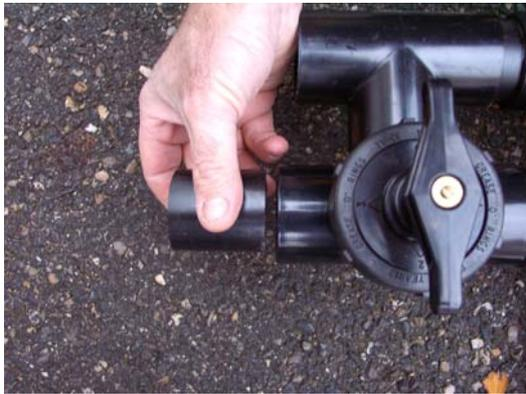
Monter les deux unions avec les embouts métriques et les coller aux tubes.
